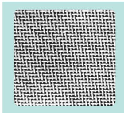
縦線と横線とが一定の間隔を保ち、相互に2本以上づつ乗り越しているもの、およびこれに類するもの。(線が2本またがるため、線の屈曲角度が大きく比較的太い線の使用が可能です。)
